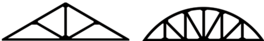
Esquemes de dos models d'encavallats, un de triangular i l'altre semicircular. Autor: Francesc Masana. Procedència: arxiu familiar de Rosa M. Masana.
